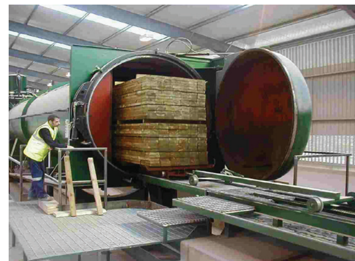
Thermowood productie in een autoclaaf.
