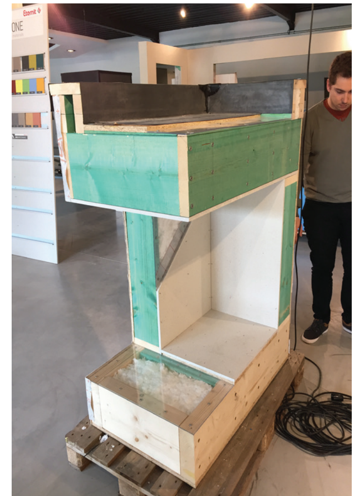
Detail van opbouw en afwerking van een woning module.
